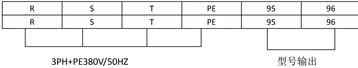
1. 电源建议配线: **QG-070LY-ZBC-3385 3\*4<sup>2</sup>+4<sup>2</sup>** 国标电缆
